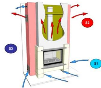
S1:Section minimum des entrées d'air de convection: 600 cm<sup>2</sup> mini
